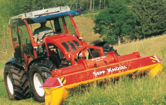
...sollten Sie achten. Doch diese gehärteten Klingen sind auch den widrigsten Bedingungen gewachsen. Pendelnd aufgehängt, sollten sie mehreren Mäh Schnitten standhalten. Sollte doch einmal eine Klinge zu wechseln sein, ist dies mit einer selbstsichernden Schraube rasch erledigt. Sicherheit steht an erster Stelle - deshalb nur original Knüsel Klingen verwenden.
