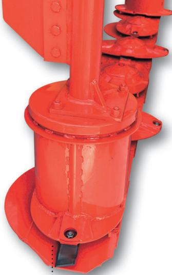
Die patentierte Aufhängung des Mähwerkes ermöglicht die Mäharbeit wesentlich näher am Traktor als bei anderen Mähwerken. Durch dieses System ist auch kein Innenschuh mehr erforderlich. So hat das Mähblatt auf der ganzen Länge die gleiche Breite. Das Ergebnis ist eine konkurrenzlos saubere Mähleistung auch bei Kuppen und Senken.
