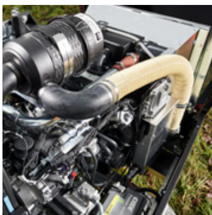
Hatz 4H50 motor met 55 kW
